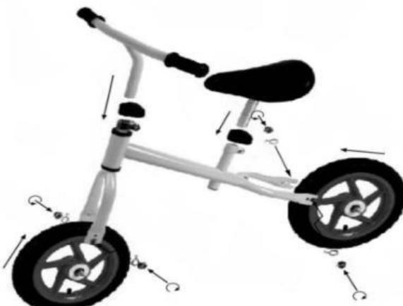
Die Konstruktion des Laufrads ermöglicht zwei Varianten der Zusammensetzung (für größere und kleinere Kinder)- durch das Umdrehen des Rahmens. Das Aufbauverfahren ist gleich, nur die vordere Gabel und der Sitz werden von der anderen Seite des Rahmens eingelegt.
